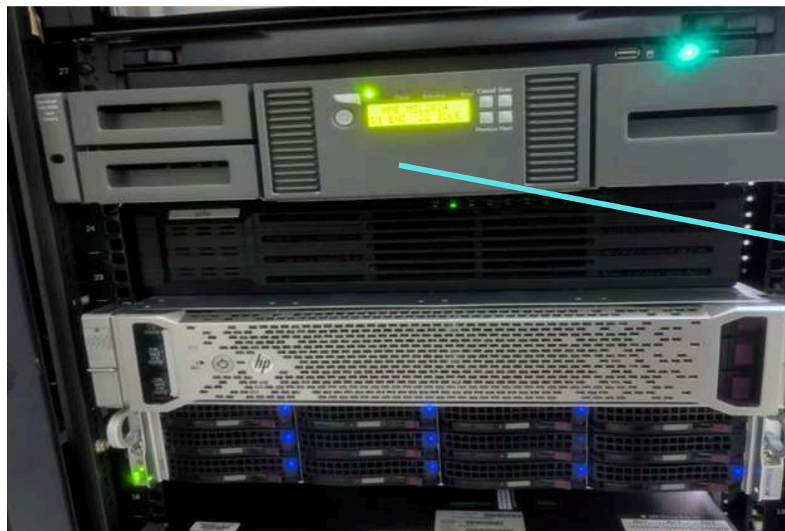
HPE MSL 2024 tape autoloader
